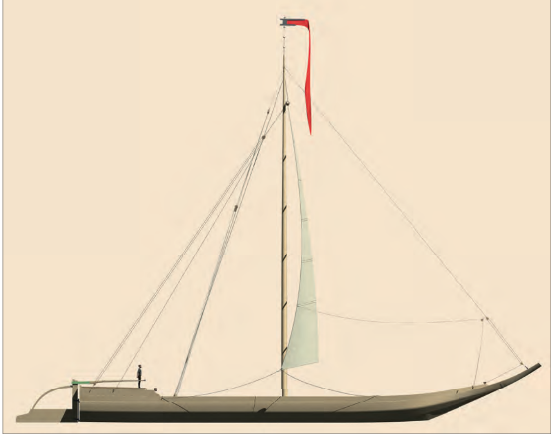
3D-Rekonstruktion einer GELLE um 1860. Grafik: Sohn
